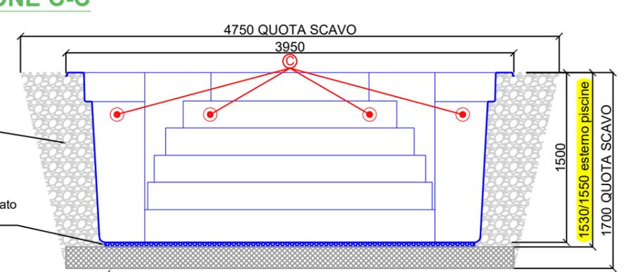
Per portanza inferiore a 2.5 kg/cm<sup>2</sup>: Massetto in CLS armato con doppia rete elettrosaldata H= 150 mm
